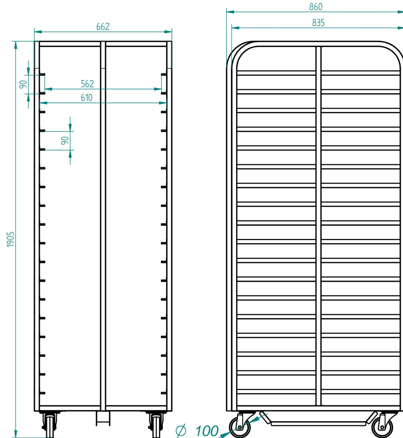
Тележка-шпилька ТШГ-18-8-6 является вспомогательным оборудованием для предприятий общественного питания и для установки и транспортировки до 18-ти противней размером 600x800 мм. Расстояние между уровнями 90 мм. Имеет поворотные колеса. Допускается использовать в ротационном пекарском шкафу РПШ-18 при приготовлении блюд, ввиду использования в тележке-шпильке термостойких колес.
