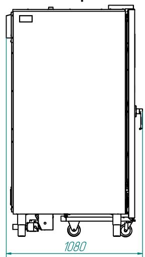
Конвекционная печь электрическая КЭП-16П-01 предназначена для приготовления пищи на предприятиях общественного питания. Управление осуществляется через панель управления, расположенное на двери печи. На панели управления имеются кнопки выбора режима работы и индикаторы, отображающие выбранный режим. В конструкции двери используется ручка с мезанизмом байонет. Дверь имеет возможность фиксации своего положения в открытом состоянии.
